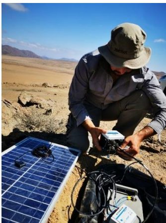
Fotografie z terénu v poušti Atacama: instalace seismické stanice. FOTO: Diego González Vidal, Valentina Valeria
