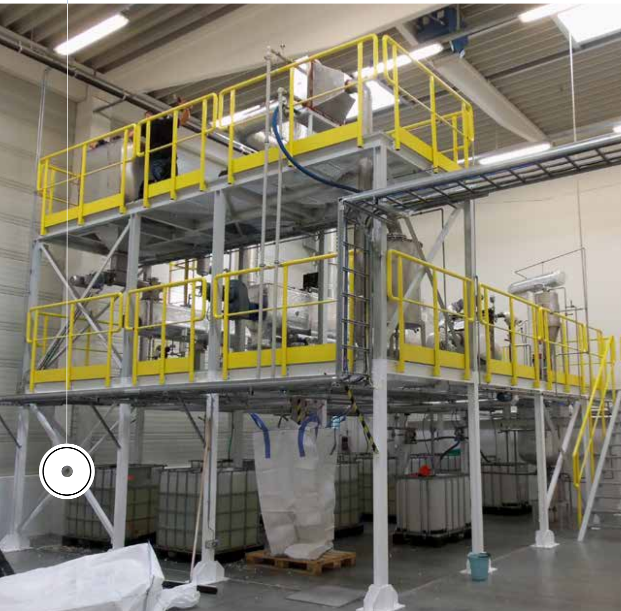
Příkladem využití výzkumných výsledků je poloprovozní zařízení recyklační metody pro rozdrůžování kompozitních obalových materiálů,
