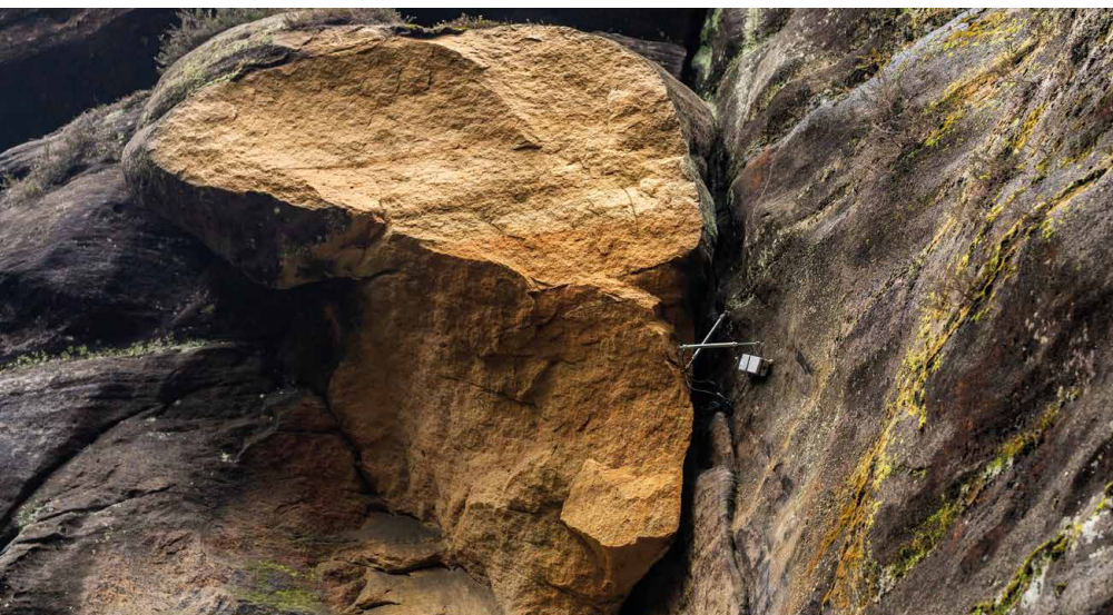
Dvojici jednoosých dilatometrů (na snímku vlevo) instalovali pracovníci z Ústavu struktury a mechaniky hornin AV ČR. Zařízení dokáže s velkou přesností měřit vzájemné pohyby bloků.
