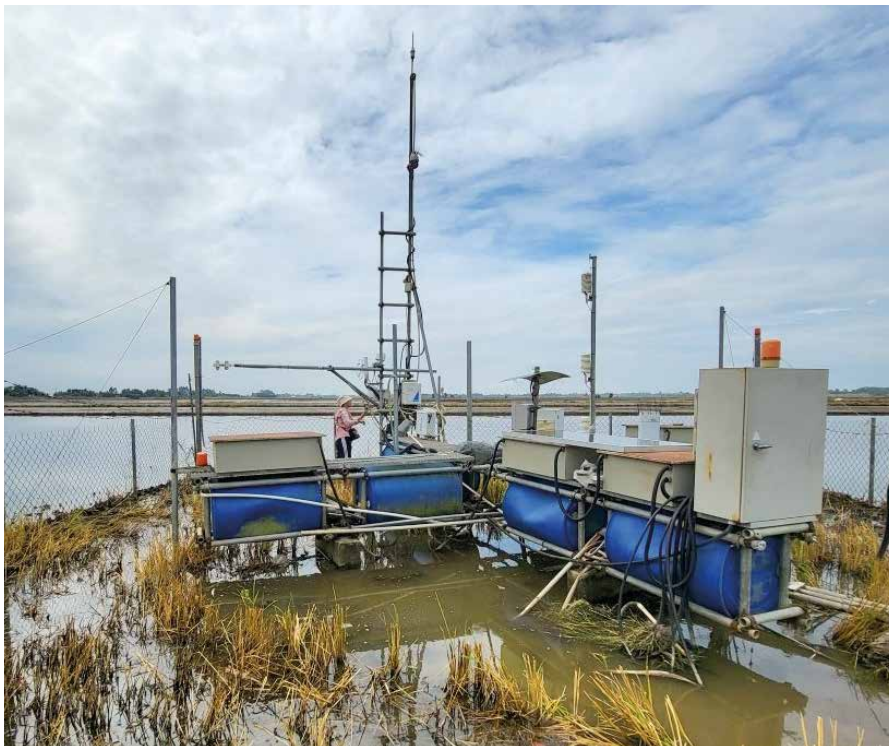
Základnu stanice VietCarbo-1 na rýžovém poli ve Vietnamu tvoří ponton z plastových barelů a duralových trubek. Když se pole zatopí, stanice plave.
