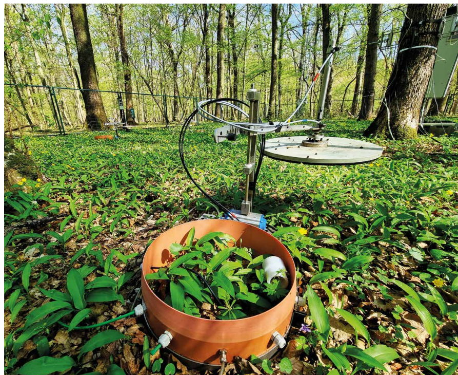
Ekosystémové stanice monitorují i situaci v zemi. Takto třeba vypadá respirační komora systému pro měření toků \text{CO}_2 z půdy v Lanžhotě.
