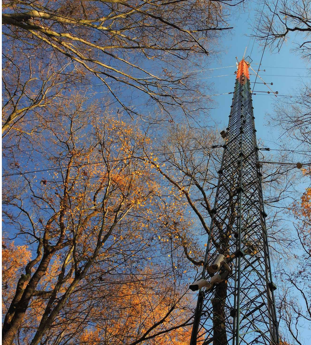
Meteorologický stožár stanice v Lanžhotě má po celé své délce nejrůznější čidla měřící teplotu a vlhkost vzduchu a další veličiny.
